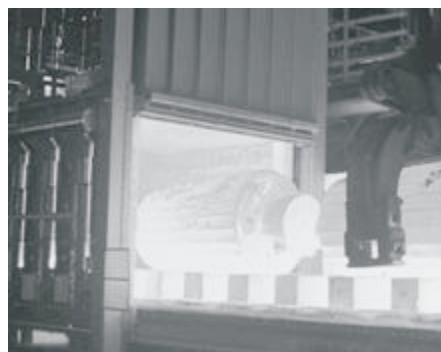
Piec z wysuwным trzonem w przemyśle metalurgicznym
