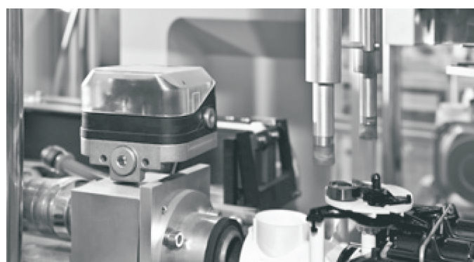
Monitorowanie podciśnienia gwarantuje poprawną pozycję elementów w trakcie w pełni automatycznego montażu gazomierzy.
